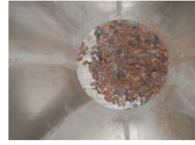
Abb. 3: Fast sauberer Laderaum eines Silowagens vor der Beladung, Reinigung durch Öffnung des Abschlusses
