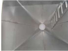
Abb. 2: Laderaum eines 2-Achs-Silowagens nach der Reinigung
